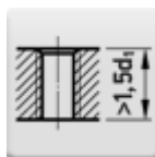
ТИП ОТВЕРСТИЯ Сквозное отверстие (длина резьбы L > 1,5xd1)
